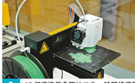
4. 3D打印機便會開始工作，時間按模型複雜程度而定，一般也需要2小時以上。
