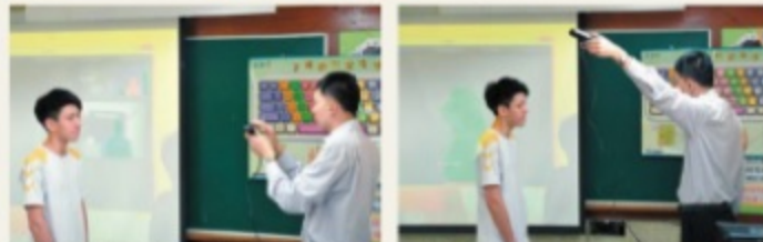
● 讓中學生（左）被掃描器掃描後，即顯示輪廓影像（背後綠色的部分）。 ● 掃描期間，若發現綠色邊緣上出現灰色部分，即邊緣有缺口，此時可調整掃描器更多角度掃描。
