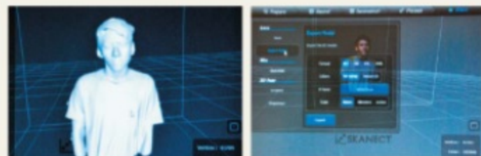
● 完成後的圖檔可使用單色記錄，此效果也較接近列印的效果。 ● 若需要較完整的彩色檔案記錄，也可再記錄以PLY格式儲存。
