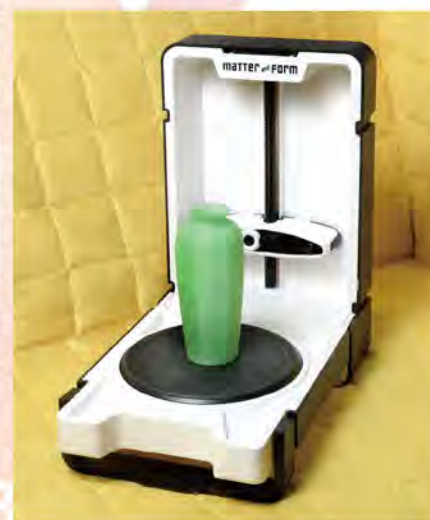
●MATTER AND FORM 3D掃描器可捕捉細節小於0.43毫米，讓學生把現實世界的物件數碼化。
