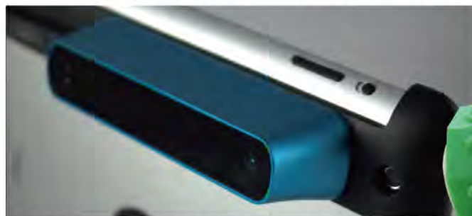
● 3D掃描器Structure Sensor尺寸小巧，亦可感應40cm - 3.5m的距離。
